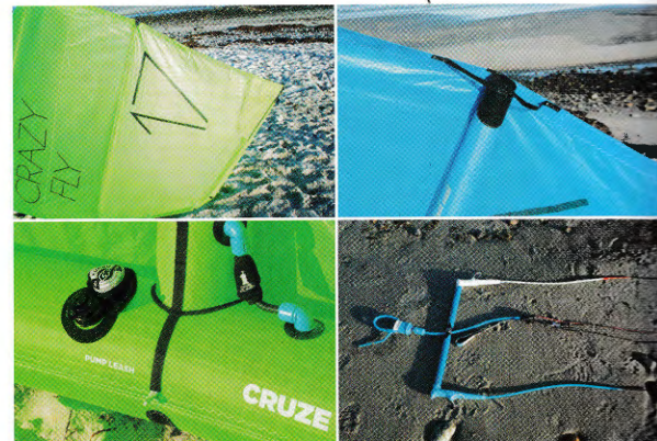
Zwei Anknüpfungspunkte hält der Cruze am Tip für die Einstellung der Reaktivität und der Drehgeschwindigkeit bereit. Besonders gut gefallen hat uns die aus einem Stück gefertigte Karbon-Bar, die nicht nur schön leicht, sondern auch sehr aufgeräumt und leicht verständlich ist. Das als Griffbelag verwendete Ledermaterial beschert dem Bar-Holm eine sehr angenehme Haptik.
